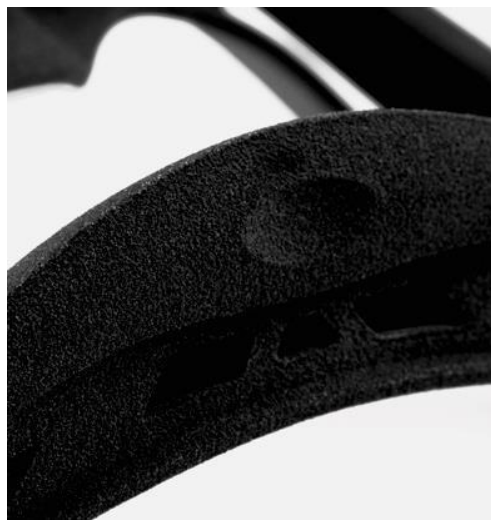
23– сурет – SLA бөлшектерінде өткір жиектер, тегіс бет және минималды көрінетін қабаттар бар. Бұл мысалда бөлік Formlabs Form 2 Жұмыс үстеліндегі SLA 3D принтеріне басып шығарылды
