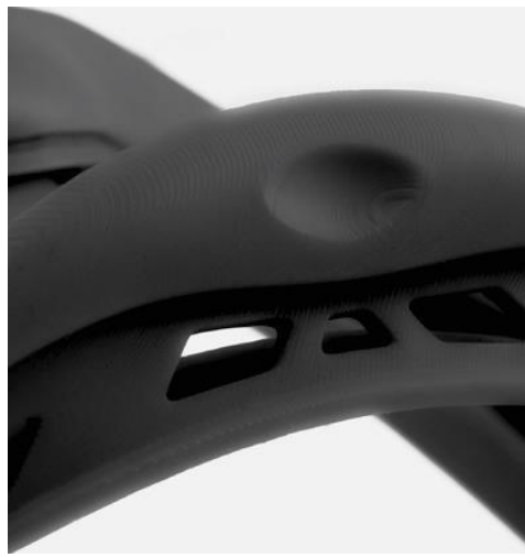
23– сурет – SLA бөлшектерінде өткір жиектер, тегіс бет және минималды көрінетін қабаттар бар. Бұл мысалда бөлік Formlabs Form 2 Жұмыс үстеліндегі SLA 3D принтеріне басып шығарылды
