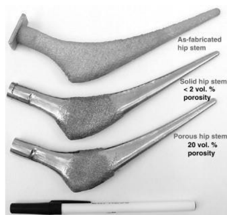
10– сурет – LENS көмегімен жасалған таза пішін, функционалды жамбас аяқтары.
