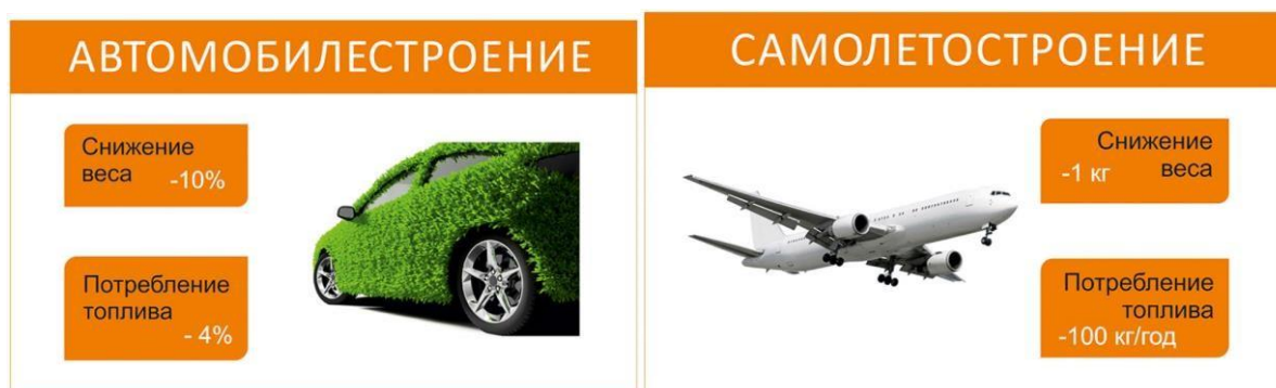
15– сурет – Аддитивті технологияларды қолдану арқылы конструкциялардың салмағын азайту
