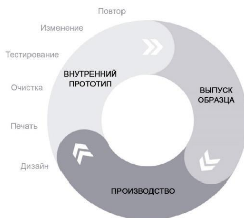
2– сурет – 3D басып шығару үрдісінің циклы
