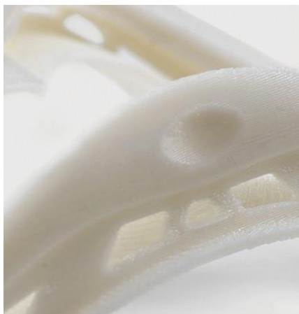
22– сурет – FDM бөлшектері көрінетін қабат сызықтарына ие және күрделі функциялардың айналасында дәлсіздіктерді көрсете алады. Бұл мысал Stratasys uprint өнеркәсіптік 3D принтерінде еритін медиамен басып шығарылды (машина бағасы 15900 доллардан басталды).
